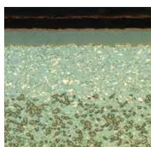
La **YBC103** dispone de una nueva tecnología de sinterización y, por lo tanto, puede utilizarse en una amplia gama de aplicaciones. Mediante el nuevo sistema de recubrimiento CVD se consigue una alta resistencia al desgaste.
